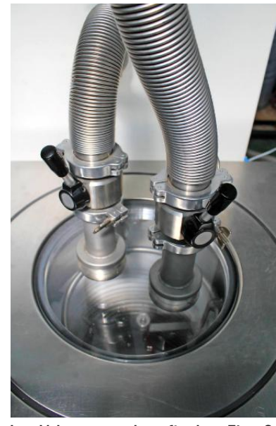
Im Vakuum verdampft das Eis. So kommt die Nässe aus dem Papier.
